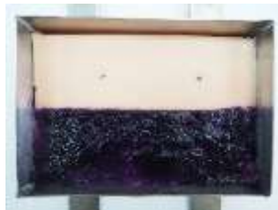
ภาพที่ 3 การเตรียมพื้นผิวแผ่นซิลิโคนเพื่อจำลองสภาพขณะมีอาหารสะสมอยู่
